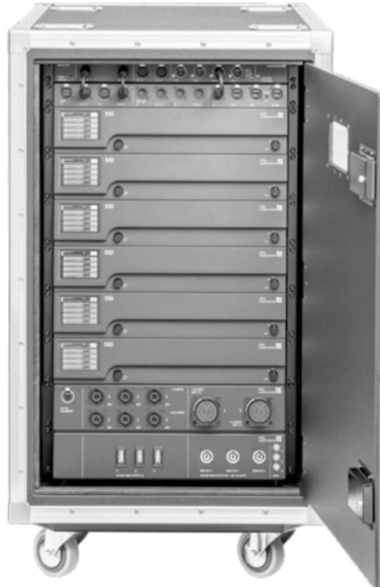
Die erforderlichen Patchkabel für die DS10 bzw. DS20 Audio Network Bridge und das I/O-Panel sind vorverkabelt. Die digitalen Ausgänge der DS10 bzw. DS20 (OUT 1/2 und OUT 3/4) sind mit den entsprechenden Eingangsbuchsen (A2 D1/2 und A4 D3/4) des I/O-Panels verbunden, um die digitalen Audiosignale in die Verstärker einzuspeisen. Für den Zugriff auf die Verstärker ist zudem der ETH3-Anschluss der DS10 bzw. DS20 mit dem ETH1-Anschluss des I/O-Panels verbunden.
